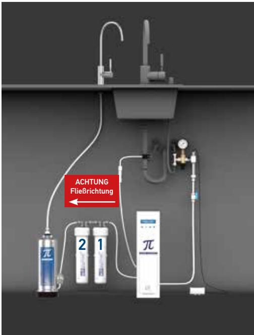
Den Schlauch aus der mittig aufgesetzten Steckverbindung des Filters 2 lösen und wieder in die obere Öffnung des PI®-Cell Vitalizers führen. Stattdessen den Schlauch von der unteren Öffnung des PI®-Cell Vitalizers in die mittig aufgesetzte Steckverbindung des Filters 2 führen.
