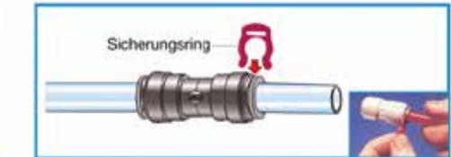
Einfügen eines Sicherungsringes Art.-Nr.: PIC1808R oder PIC1812R zwischen Grundkörper und Halteelement. Dazu den Schlauch leicht zurückziehen. Danach muß der Schlauch wieder in Richtung des Verbinders nachgedrückt werden.
