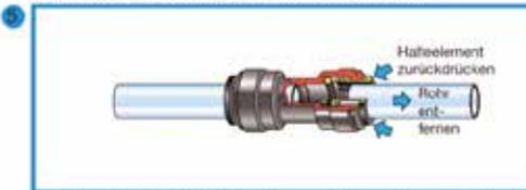
Das Rohr bzw. die Verbindung kann gelöst werden, wenn Sie das Halteelement gegen den Verbinder drücken. Der Verbinder kann erneut benutzt werden.
