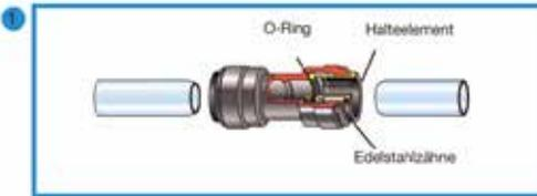
Das Rohr rechtwinklig, gratfrei abschneiden und sicherstellen, daß das Rohr keine scharfen Kanten, Längsrillen oder sonstige Beschädigungen aufweist.
